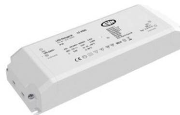
Der kurzschlussfeste Sicherheitstransformator kann problemlos beim Möbelbau zum Einsatz gebracht werden, da die MM-Kennzeichnung gegeben ist. Der Anschluss primärseitig und sekundärseitig erfolgt durch Schraubklemmen, welche für Kabel von 0,75mm<sup>2</sup> - 2,5mm<sup>2</sup> geeignet sind. Technische Daten: Versorgungsspannung: 100-240V/AC und 180-250V/DC, ta: -20°C - 50°C, tc: 80°C, Powerfaktor: 0,95.
