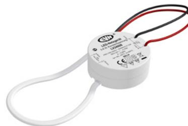
Der kurzschlussfeste Sicherheitstransformator lässt sich auf Grund der kleinen Bauform perfekt in Schalterdosen verbauen, kann aber auch beim Möbelbau zum Einsatz gebracht werden, da die MM-Kennzeichnung gegeben ist. Die Anschlussleitungen haben eine Länge von 14cm primärseitig und 17cm sekundärseitig. Technische Daten: Versorgungsspannung: 100-240V/AC und 180-250V/DC, ta: -20°C - 50°C, tc: 80°C, Powerfaktor: 0,90.
